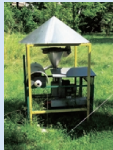
Deux systèmes de prélèvement d'air à haut volume à l'écluse de Gamsheim et au Jardin botanique de l'ULP.
