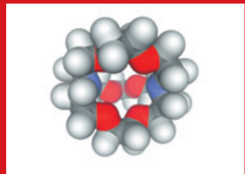
Figure 5 : modèle moléculaire d'un cryptant, capable de reconnaître et d'accueillir spécifiquement en son centre certains ions métalliques.
